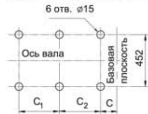
Расположение отверстий для крепления вентилятора
